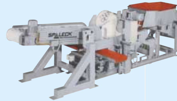
Doppelseparierung mit Magnetseparatoren MS und MSE.
